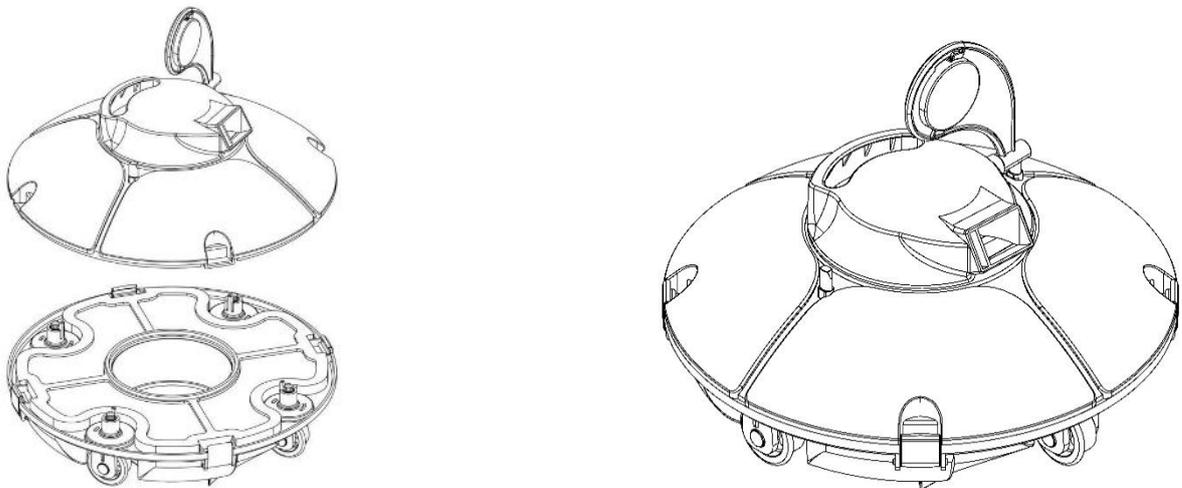
f. Positionner le capot supérieur suivant la flèche au trou du châssis.
