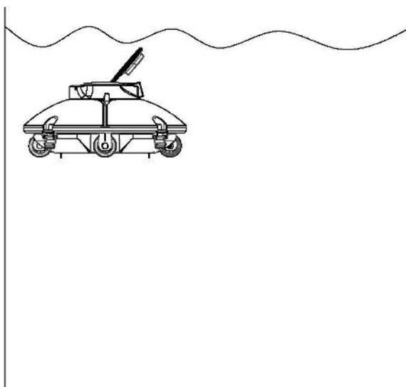
b. Lors de l'immersion ou de la sortie du robot, positionner le robot correctement sur ses roues (le dessous du robot face au fond de la piscine) pour ne pas endommager la piscine par les pièces pointues du robot.
