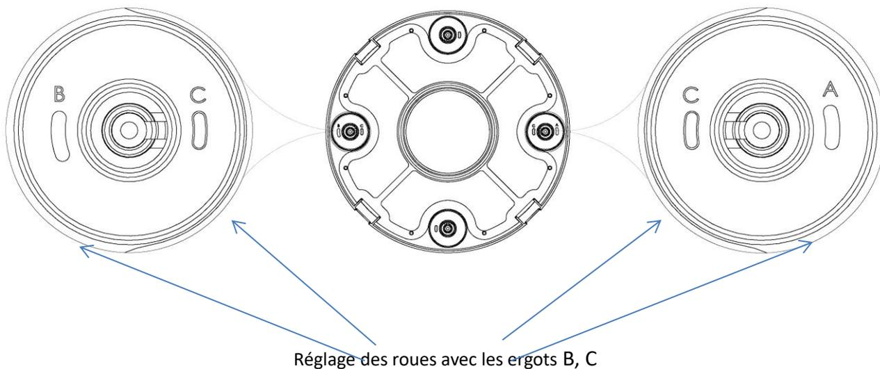
Le positionnement A, B, C est indiqué sur le châssis. Les roues sont installées par défaut A et C à l'usine.
