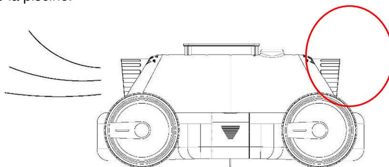
Pour certains bassins spécifiques, le mode de balayage pourrait être utilisé pour souffler les débris situés dans les angles et renvoyer de cette manière les fines particules par le système de filtration principal de la piscine
