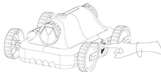
Faire descendre l'appareil dans l'eau comme indiqué dans la fig. de gauche en le vidant **COMPLÈTEMENT DE L'AIR EMPRISONNÉ** ET le positionner correctement sur ses roues
