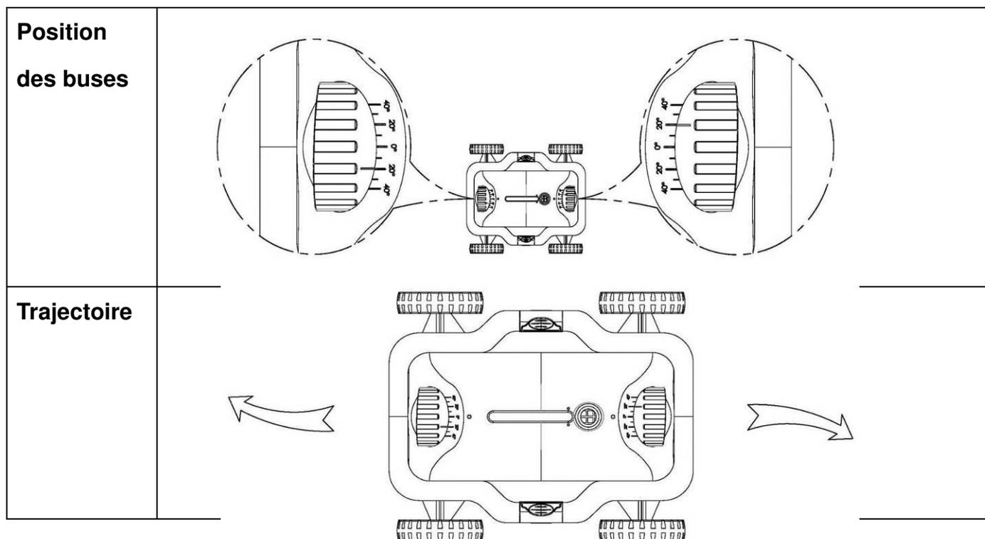
Remarque : en raison des différentes formes de piscine, et la réglage des buses, le déplacement sera un peu différent dans la réalité.
