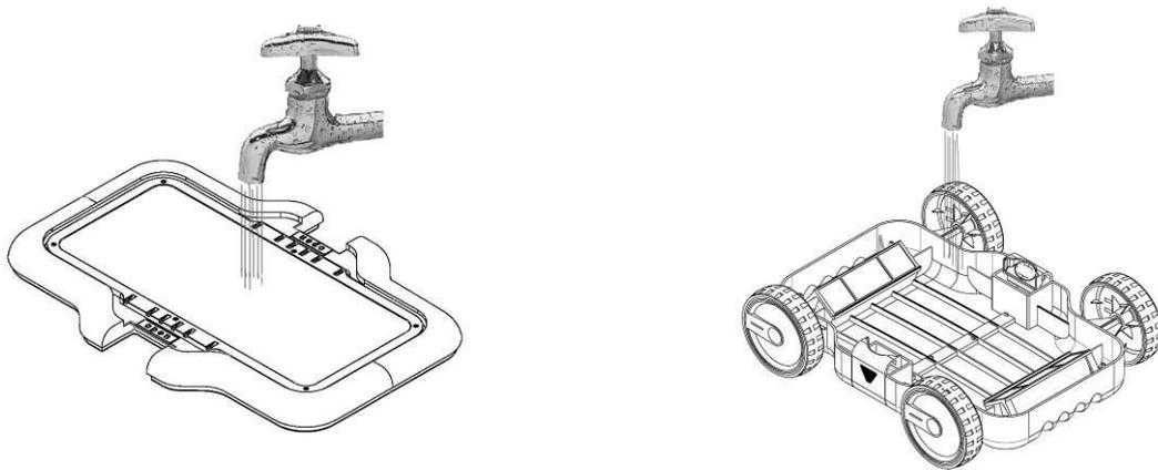
Après l'avoir nettoyé, posez le filtre sur le plateau, posez le capot et verrouillez le tout en appuyant latéralement sur les loquets de fermeture jusqu'à entendre un déclic.
